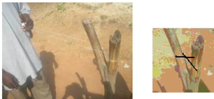
Figura 47. Galho de uma árvore em forma de “Y” usado para enrolar a linha do tear
