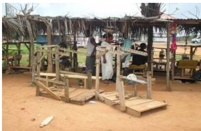
Figura 18. Estrutura de um tear artesanal de único Headle
