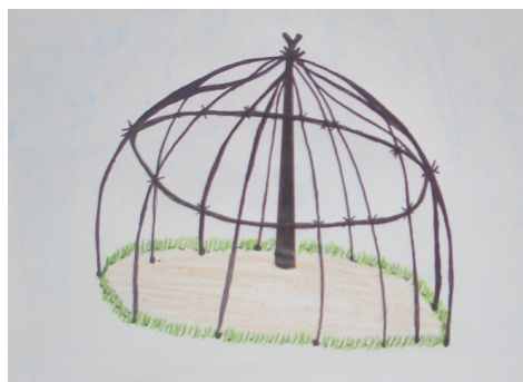
Figura 25 – esqueleto da maloca redonda
